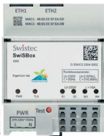
Bild 2: Beispiel einer Steuerbox mit vier bistabilen Relais, vergoldeten Wechslerkontakten bis 16A/230V, RTC-Gangreserve > 24h, Astro- und Feiertagskalender, sekundengenauem Schalten bei periodischen Fahrplänen sowie vorbereitet für digitale Schnittstellen (EEBUS, KNX)
