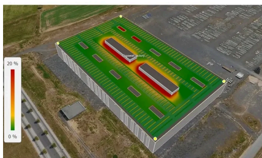
PV-Anlage mit Verschattungssimulation
